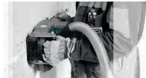
**Mauernutfräse für das Fräsen einer fertigen Nut bis 30 mm Breite und 38 mm Tiefe**
