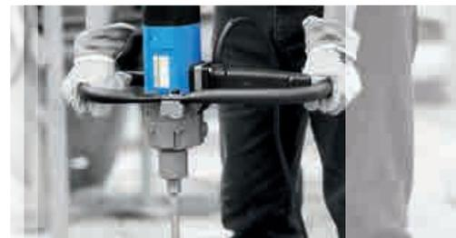
**Schnellmischer mit 2-Gang-Getriebe** für zähes Rührgut **bis 100 kg**
